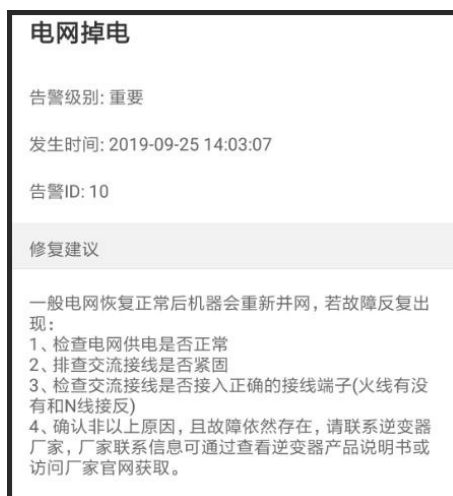
图 7-7 故障告警记录
